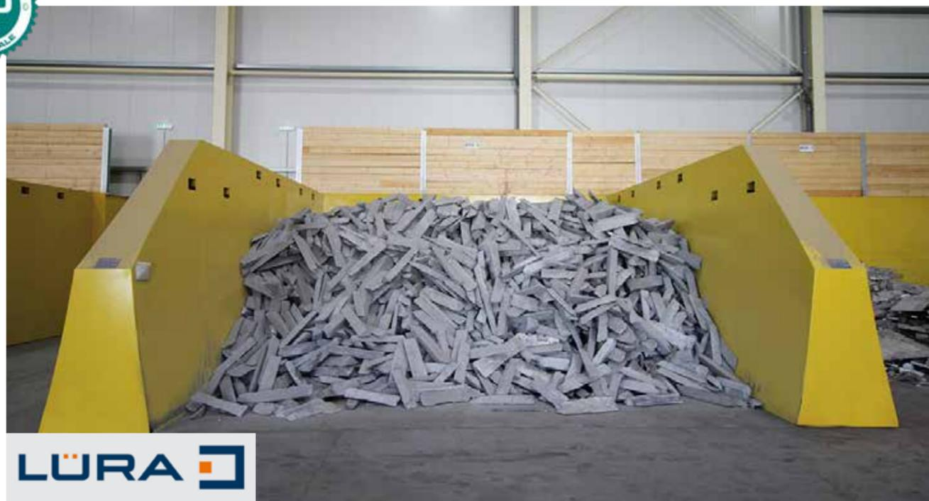
Les cloisons en acier LURA permettent la **mobilité** sur le site d'exploitation, la **modularité** et une **capacité d'extension importante** sur tous types de sols stabilisés. Elles résisteront à toutes les sollicitations d'un site de traitement du déchet : le vent, les impacts d'engins, le feu, etc... et même le poids d'une couverture métallo-textile.
