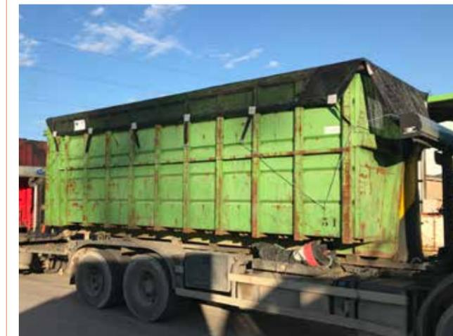
**+** Netzverstärkung an den Enden der Flügel zum Schutz gegen Reibung am Container - Verlängerung der Flügel zur vollständigen Abdeckung des Containers.
