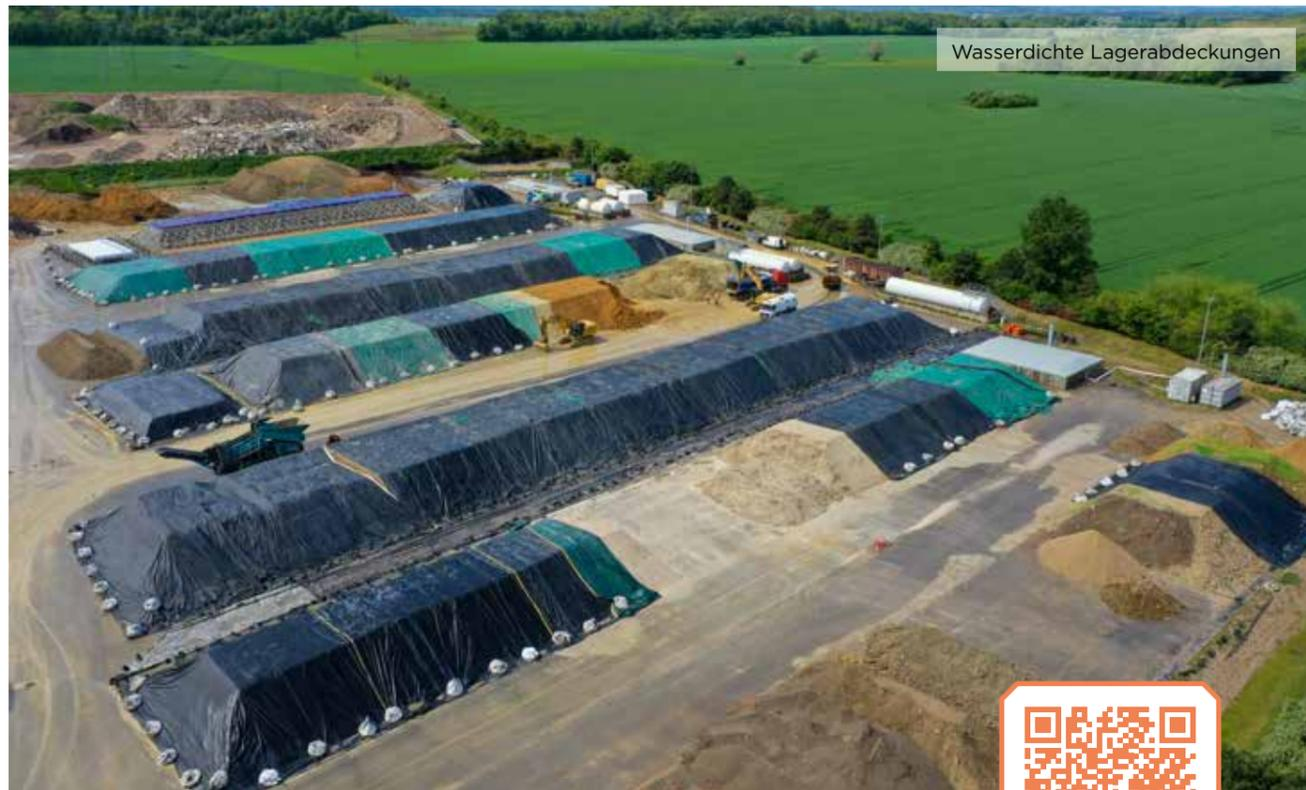
Abdeckung aus **hochdichtem Polyethylen** grün beschichtetem Polyethylen. Ausgestattet mit einem Hebenetz für den einfachen Transport auf den Baustellen. Plane gefaltet und gefertigt **entsprechend den Bedürfnissen des Betriebs**, Rolle/Abwickler, um das Bewegen der Decken zu erleichtern **(bis zu 10 m breit)**.
